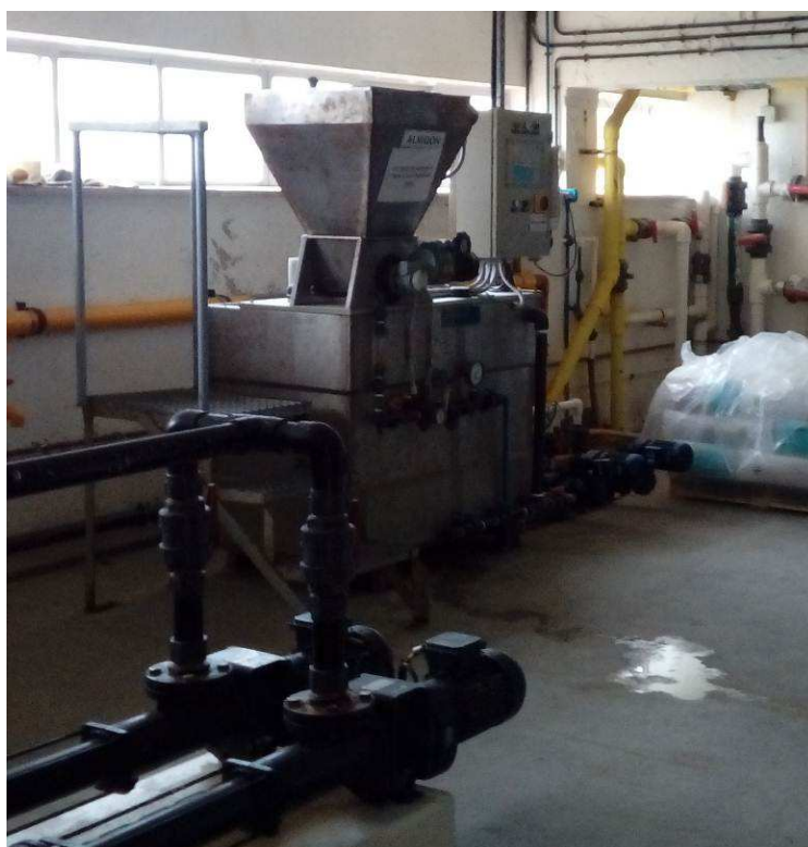
Equipo de preparación compacto de almidón
